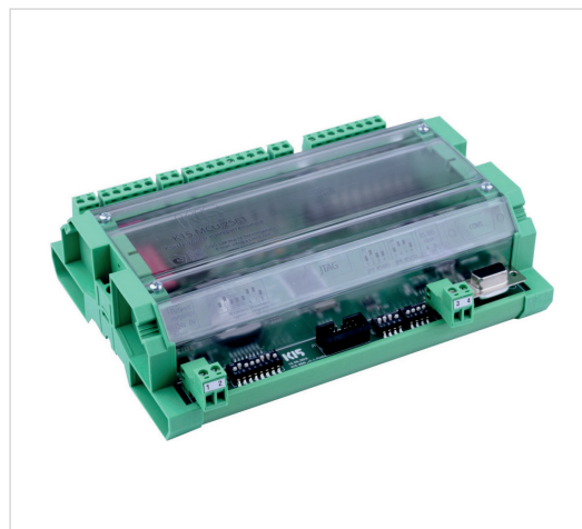
Внешний вид контроллера «K15.MCU.2561»
