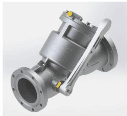
Все компоненты отсечного клапана выполнены из алюминиевого сплава. Уплотнения из FPM-NT (Viton®). Конструкция отсечного клапана позволяет легко и быстро произвести замену всех деталей и уплотнений. Поверхность алюминиевых деталей обработана методом анодирования, для придания прочности.
